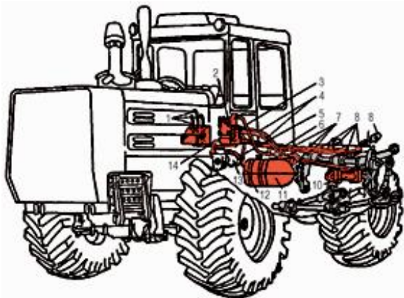
Рис. 77. Схема гідравлічної системи трактора ХТЗ-17021: 1 – важелі керування; 2 – золотниковий розподільник; 3, 4, 5, 7, 12 – маслопроводи; 6 – фільтр і індикатор масляного бака; 8 – з'єднувальні муфти; 9 – начіпний механізм; 10 – силовий циліндр; 11 – масляний бак; 13 – шестеренчастий насос; 14 – привод і механізм включення. клапани, з'єднувальні муфти 8).
