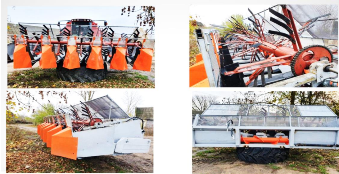
Рис.1. Модернізовані технологічні засоби для збирання рицини
