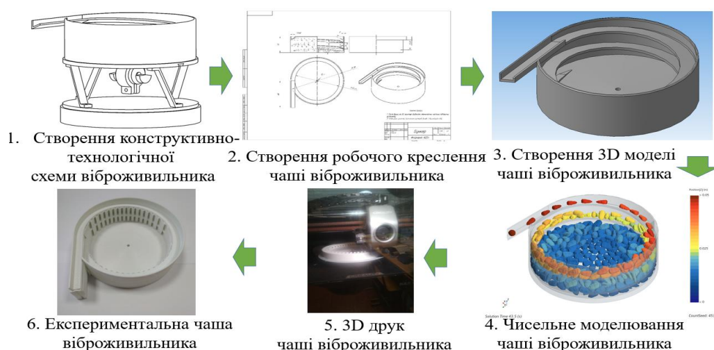
Рис. 1. Етапи проєктування та виготовлення експериментального зразка вібраційного спірального живильника для дозування поодинокого насіння соняшнику
