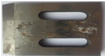
Рисунок 4. Конструкція ножа подрібнювача для приготування розсипних кормо сумішей з самозагострювальною ріжучою крайкою, виготовляється з експериментального порошкового матеріалу
