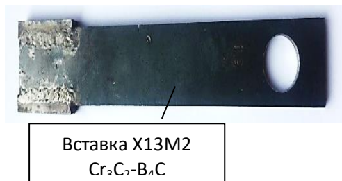
Рисунок 3. Конструкція молотка-модуля установки для приготування повнораціонних кормів БМК-1, УМК-Ф-2, армований змінними вставками (пластинами) з карбідосталі Х13М2- Cr_2C_3 - V_4C [4]
