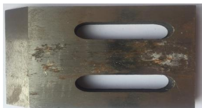
Рисунок 4. Конструкція ножа подрібнювача для приготування розсипних кормо сумішей з самозагострювальною ріжучою крайкою, виготовляється з експериментального порошкового матеріалу
