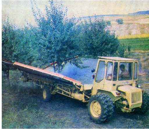
Рис.1. Комбайн для збирання плодів МПУ-1А.
